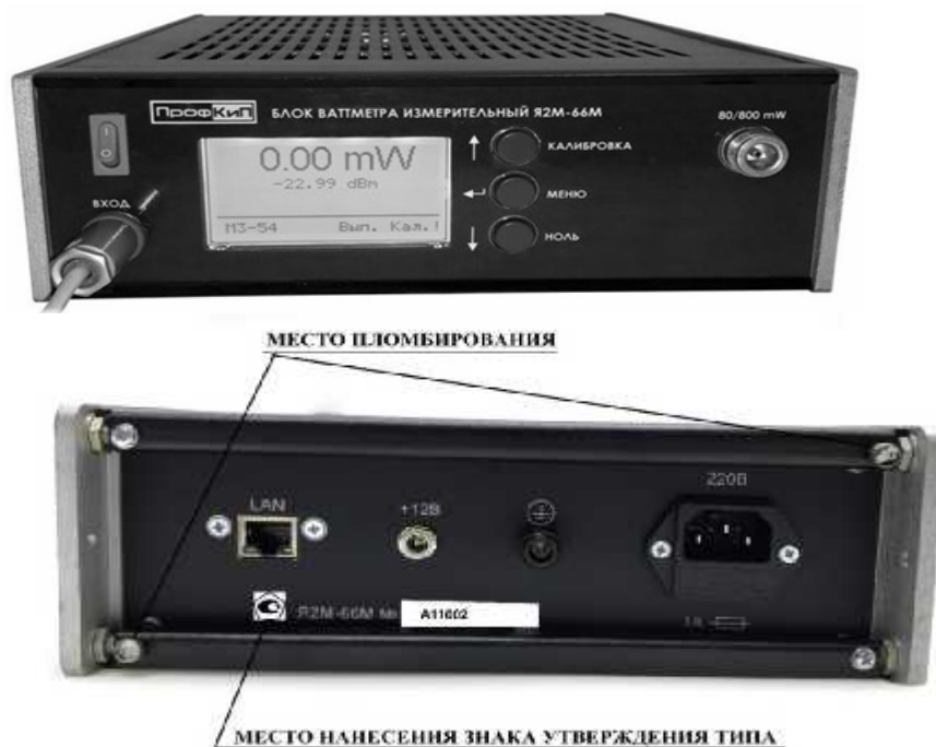
Рисунок 1 - Общий вид блока ваттметра измерительного ПрофКиП Я2М-66М и схема пломбирования от несанкционированного доступа
